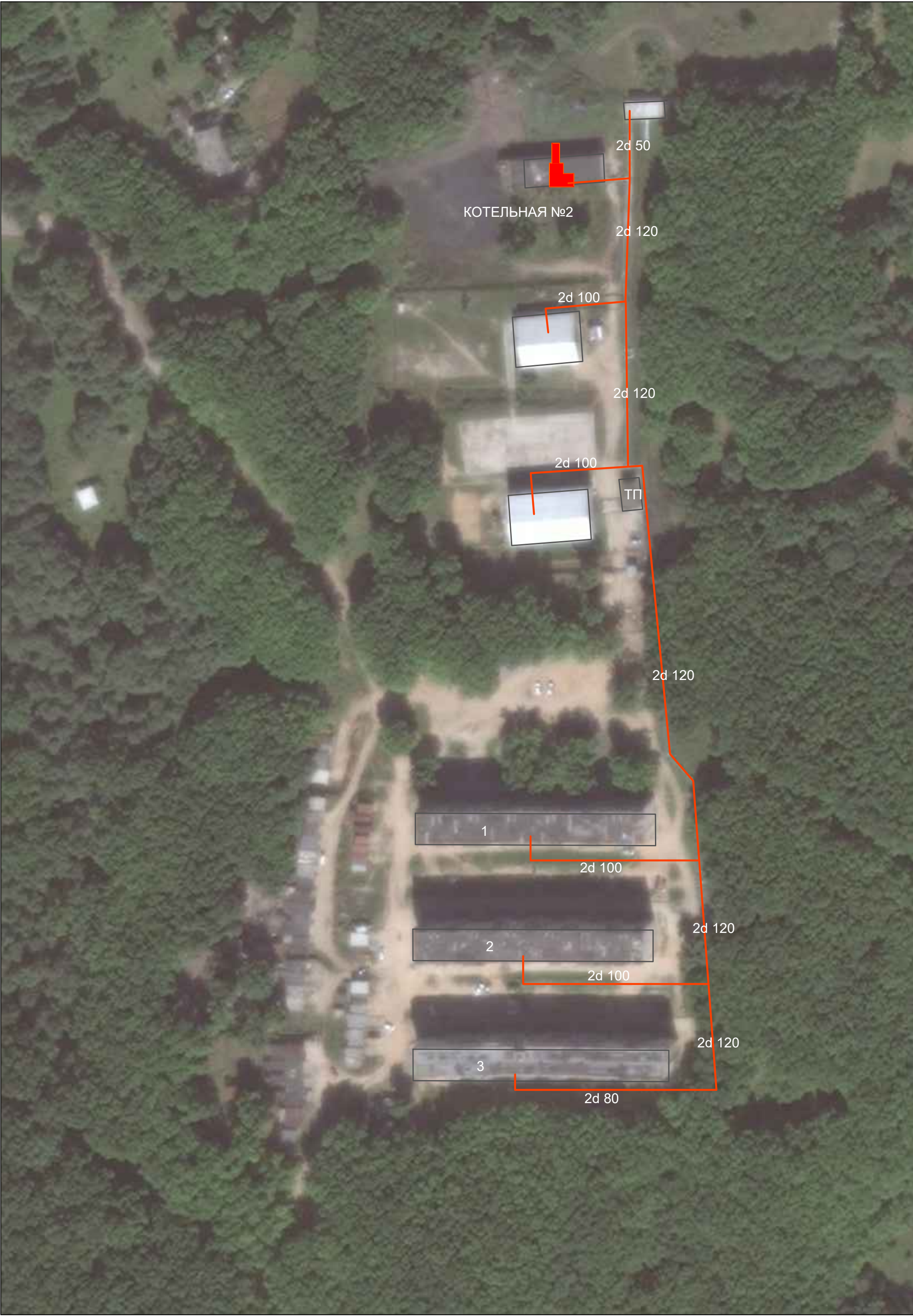
Схема теплоснабжения с. Тимофеевка, котельная №2 фрагмент территории
